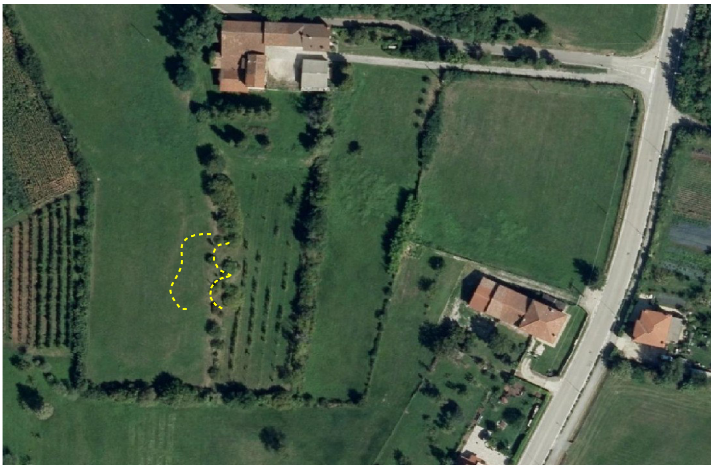
Figura 6.1 Rappresentazione schematica delle nicchie di frana individuate nel terreno, rappresentative di uno scoscendimento superficiale che interessa il primo metro, circa, di terreno.
