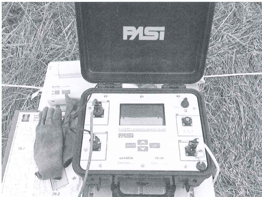
Foto 5: sismografo a 3 canali della ditta PASI, modello LCM-3
