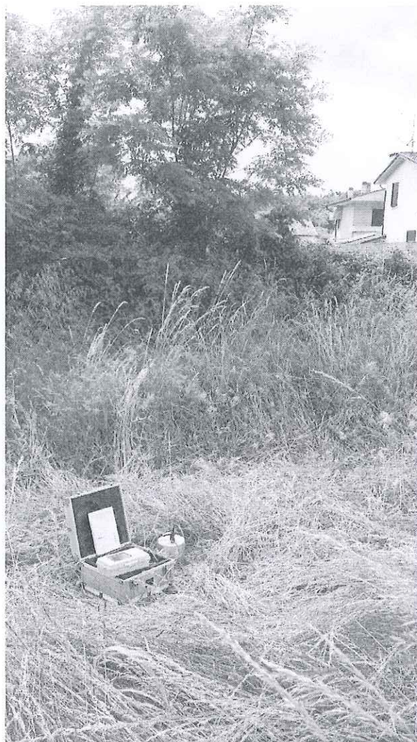
Foto 7: Esecuzione dell'Indagine Sismica Passiva con tecnica "HVSr" Sensore sismico 3D frequenza 2Hz e Sismografo digitale Vibralog a 24 bit (M.A.E.)
